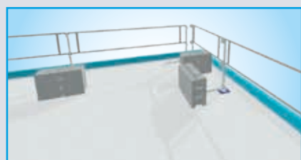
Assemblé avec des garde-corps double d'échafaudage Blitz.
